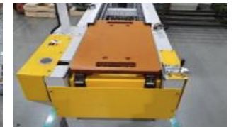
협착지점 커버 설치
