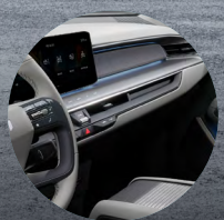
크래쉬 패드, 도어 트림 로어 바이오 PE (Bio PE)
