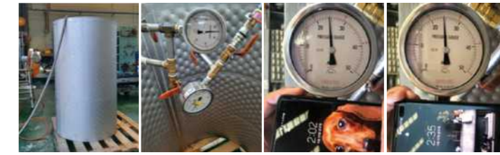
[수압 테스트] 24. 1bar, 30min hold. (Thermal cycle 전/후 동일)
