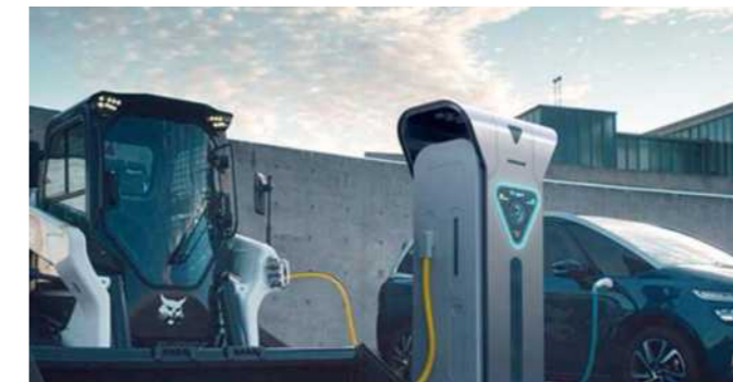
* 수소와 전기, 열을 생산하는 Tri-gen을 통해 완전 전동식 로더와 수소차를 동시에 충전하는 콘셉트 이미지
