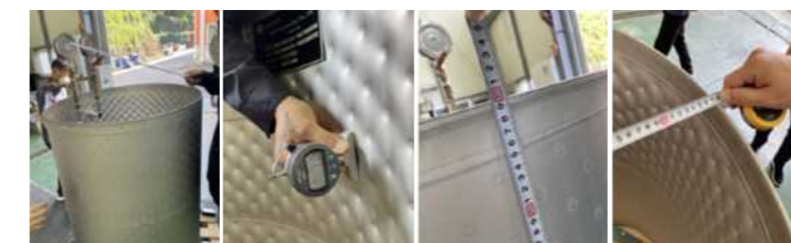
[용접 변형 Visual 검사] 용접부 Visual 및 Form3 기반 Dimension 검사 진행(Thermal cycle 이후 측정하여 Spec 준부 여부 및 Data 비교)
