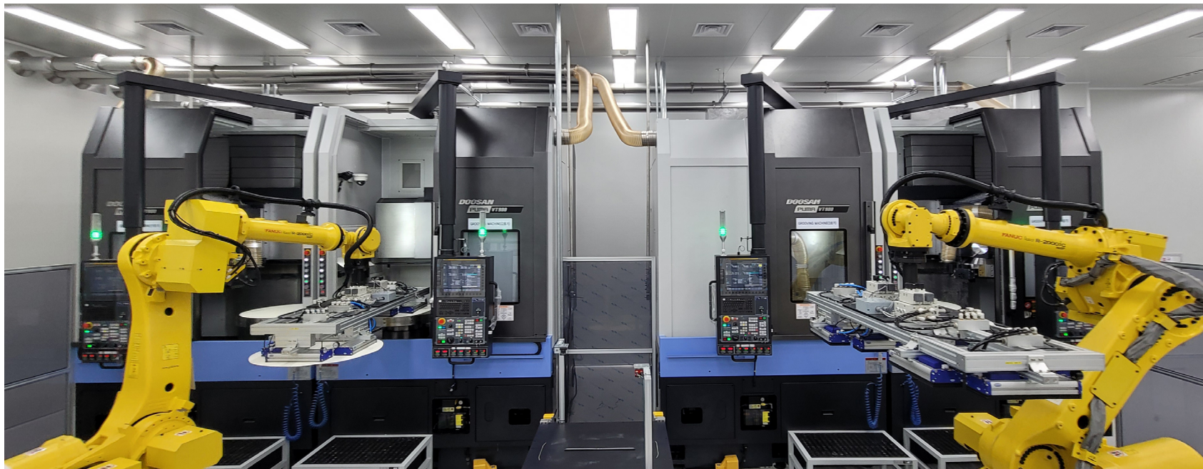
SK엔펠스 천안 공장에서 로봇팔로 CMP 패드를 제작하는 모습
