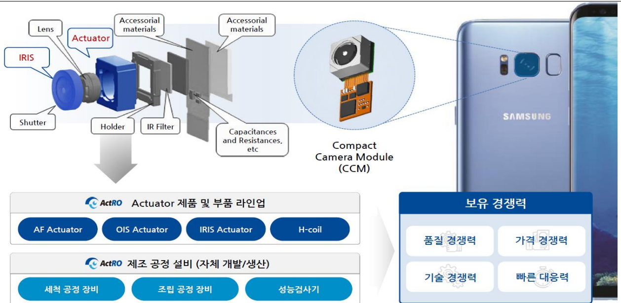
그림82. 스마트폰 카메라모듈의 핵심 부품 Actuator
