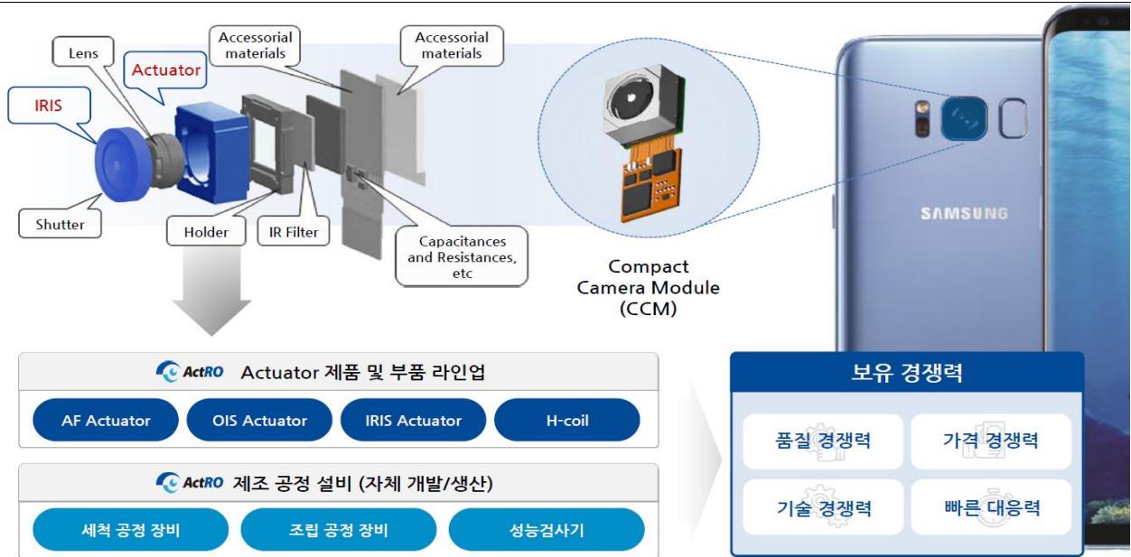
그림4. 스마트폰 카메라모듈의 핵심 부품 Actuator
