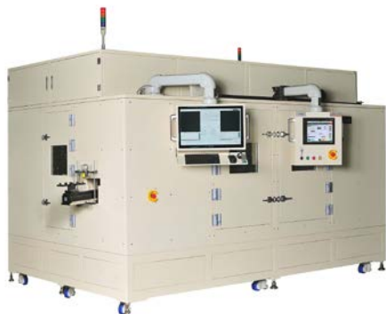
그림 137. 이노메트리의 X-ray 자동차 검사장비
