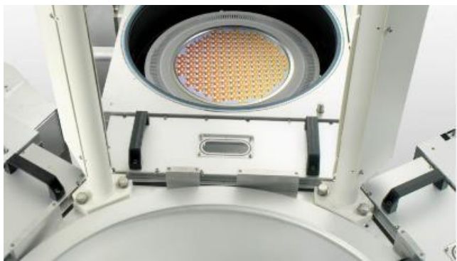
Exhibit 2. 주요 고객사의 Dry Etching 장비
