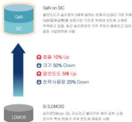
[그림3] 기존 소재와의 비교 (GaN on SiC / Diamond)
